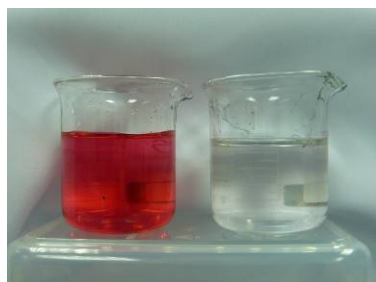
圖 7(a) 反應性染料(Red 3)染液吸附前後比較圖
