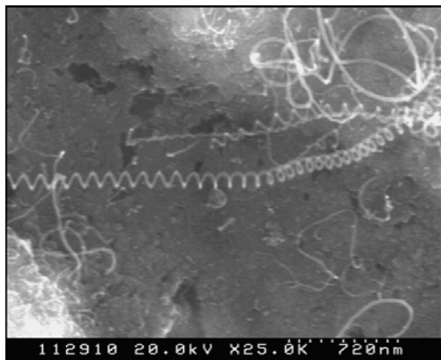
圖 24 鈷當觸媒再以 CVD 成長的 CNT 具有彈簧般的捲曲結構
