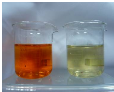
圖 10(a) 酸性染料(CI Orange 10) 染液吸附前後比較圖
