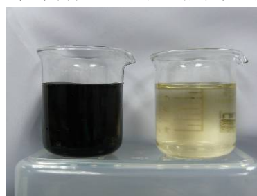
圖 8(a) 反應性染料(CI Black 5)染液吸附前後比較圖
